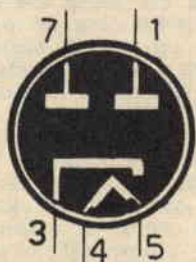
6CA4 DOPPIO DIODO RADDRIZZATORE (zoccolo noval)
