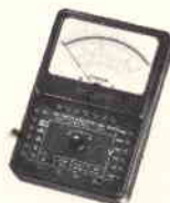
ANALIZZATORE TC40 strumento ad ampia scala 40000 ohm/volt
